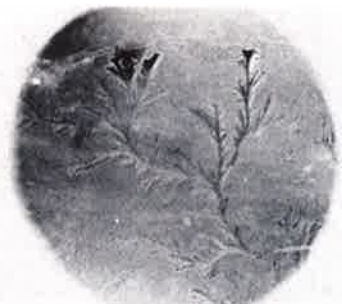
Bild 1: unaufbereitetes Wasser, astförmige Kristalle, 200fache Vergrößerung
